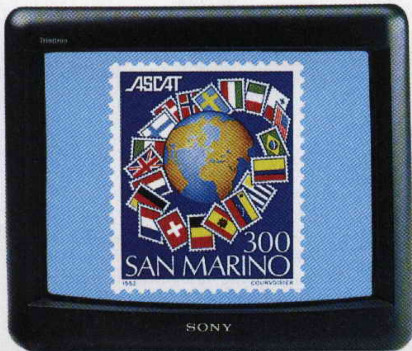
Fig.8 Constatato che potevamo ottenere degli elevati ingrandimenti senza perdere in definizione, abbiamo provato a collocare un francobollo a circa 1 centimetro dall'obiettivo, poi abbiamo regolato la sua messa a fuoco. Questo francobollo risulta ingrandito di circa 14 volte.
